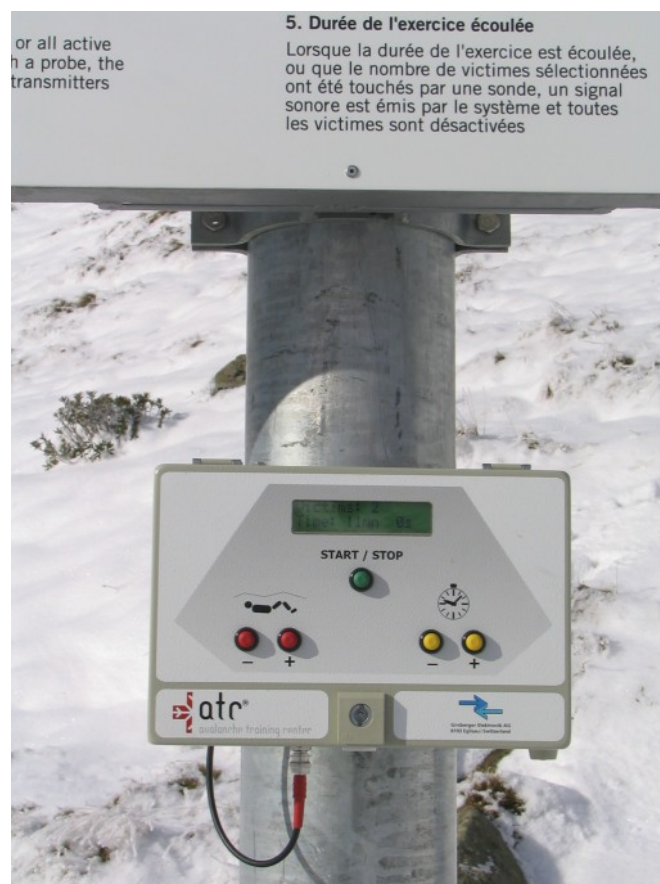
Unità di comando fissa tipo FCU per 16 emettitori ARVA con segnalazione dei toccati
