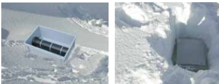
Emetteurs DVA télécommandables type RTX 457 LT avec surface tactile pour le sondage
